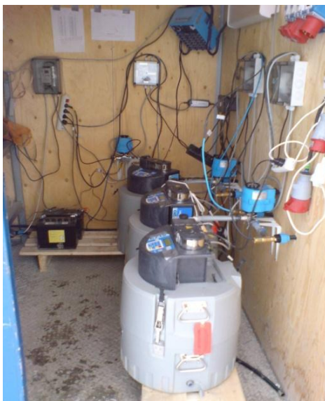
Figur 10: Mätstation Lagga, Uppsala. Automatisk provtagningsutrustning.
